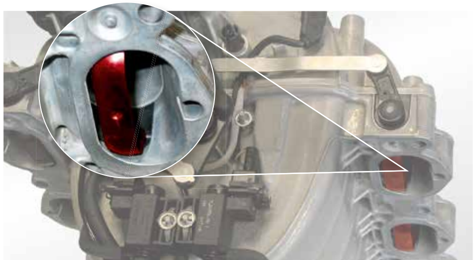
Tumbleklappen (rot hervorgehoben) im PIERBURG Saugrohr z. B. in der Mercedes E-Klasse 500
